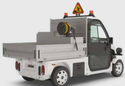
**6** Plateau + nettoyeur haute pression 130 bars - Cuve de 200L
