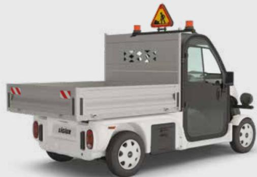
**2** Plateau 3 ridelles fixe ou basculant avec vérin hydraulique
