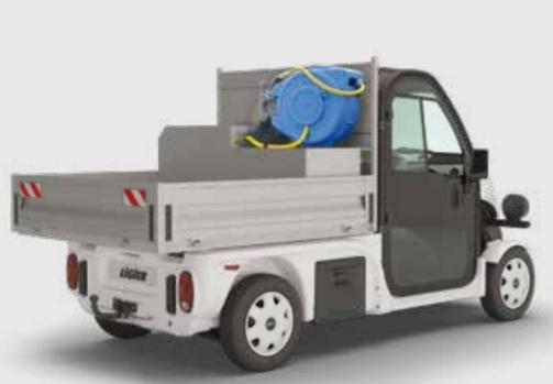
**5** Plateau + système d'arrosage et pulvérisation basse pression comprenant : cuve 200L, tuyau 15m, lance télescopique d'arrosage, pompe
