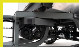
Moteur sous châssis arrière : réduction de l'exposition et du bruit
