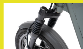
Fourche simple T suspendue permettant d'amortir les chocs
